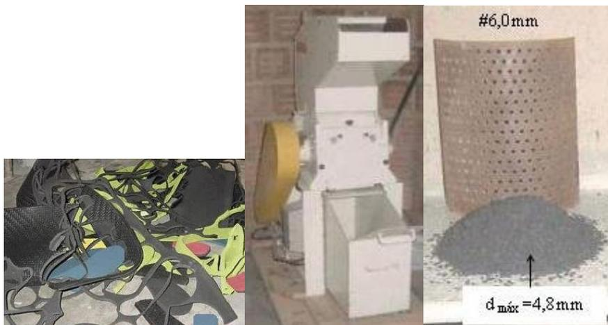
**Figura 2.** Aparas e Retalhos de EVA (A), Moinho de facas utilizado no beneficiamento do EVA (B) e peneira utilizada na separação do material (C)
